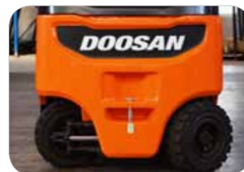
Optimierter Lenkwinkel BT (3-Rad): 90° BX (4-Rad): 86°
