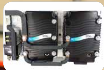
Stabiler und zuverlässiger Betrieb durch Curtis Steuerung Schutzklasse IP65
